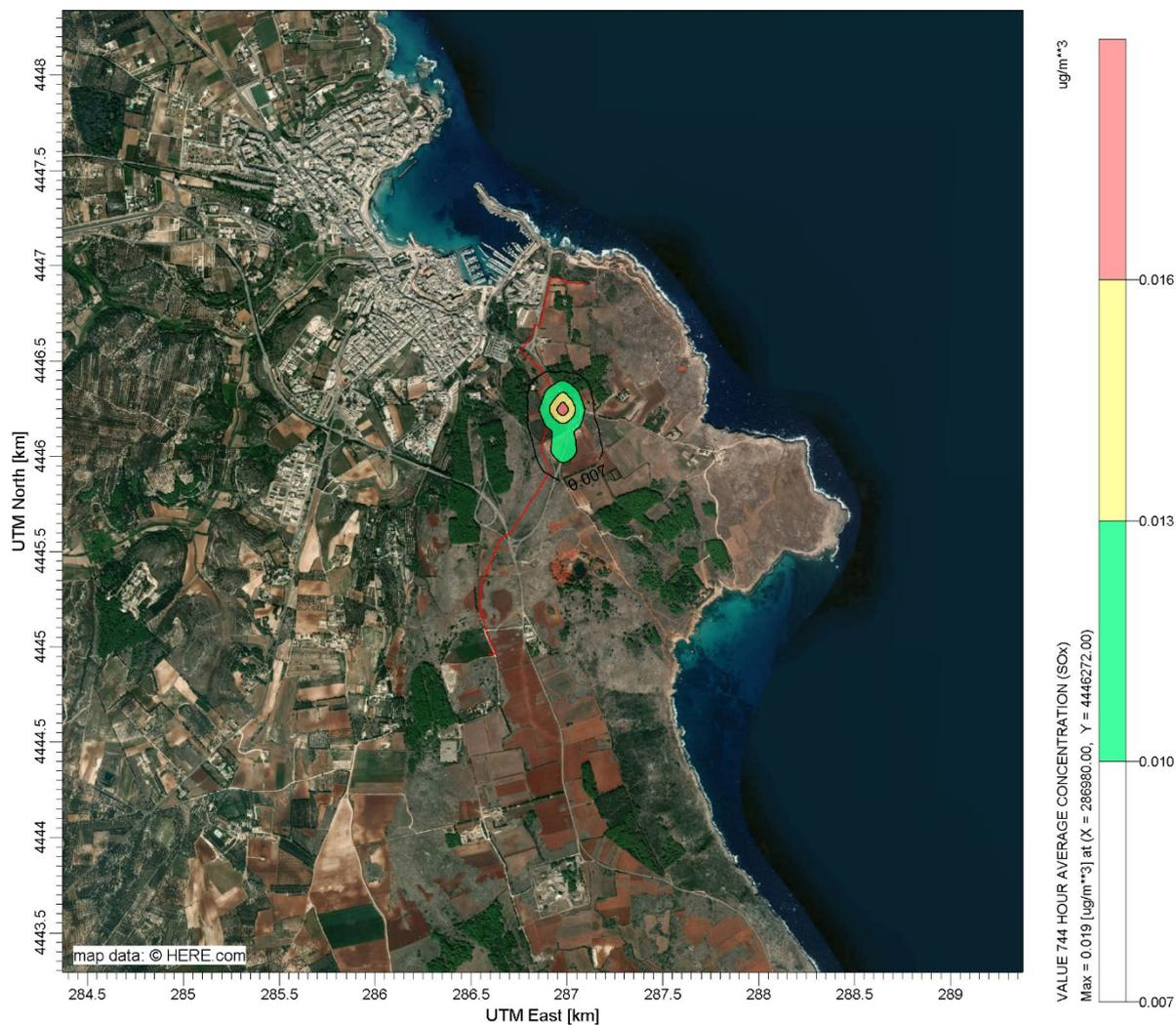
Figura 5.29: Fase Realizzazione del Metanodotto On Shore, Tratto 2 - Mappa di Iso-concentrazione, Media Mensile delle Concentrazioni di SO<sub>x</sub> (Gennaio)
