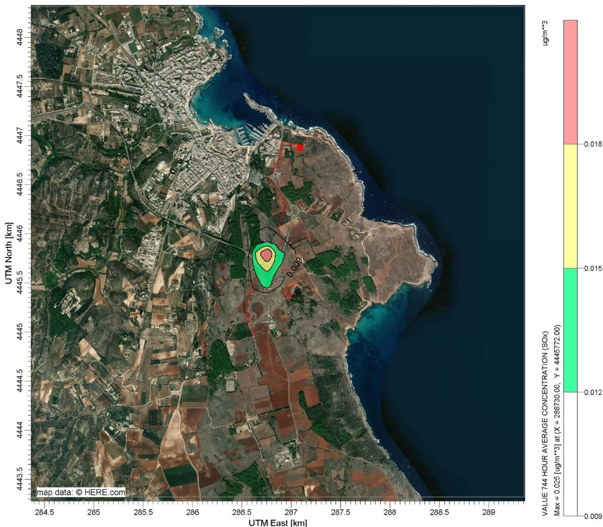
Figura 5.30: Fase Realizzazione del Metanodotto On Shore, Tratto 3 - Mappa di Iso-concentrazione, Media Mensile delle Concentrazioni di SO<sub>x</sub> (Marzo)
