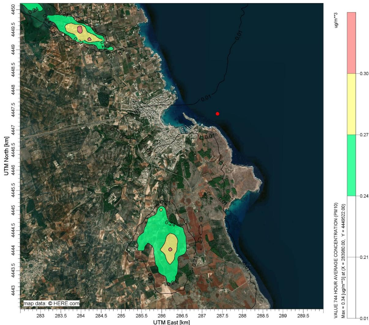
Figura 5.6: Fase Realizzazione del Metanodotto Off Shore - Mappa di Iso-concentrazione, Media Mensile delle Concentrazioni di PM10 (Ottobre)
