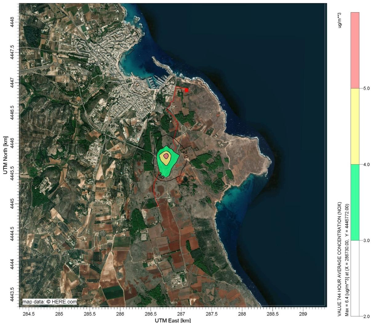
Figura 5.21: Fase Realizzazione del Metanodotto On Shore, Tratto 3 - Mappa di Iso-concentrazione, Media Mensile delle Concentrazioni di NO<sub>x</sub> (Marzo)
