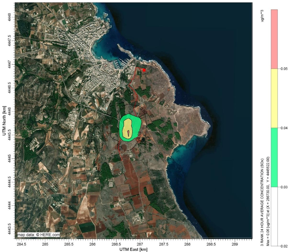
Figura 5.27: Fase Realizzazione del Metanodotto On Shore, Tratto 3 - Mappa di Iso-concentrazione, 3° Valore delle Concentrazioni Giornaliere di SO<sub>x</sub> (Marzo)
