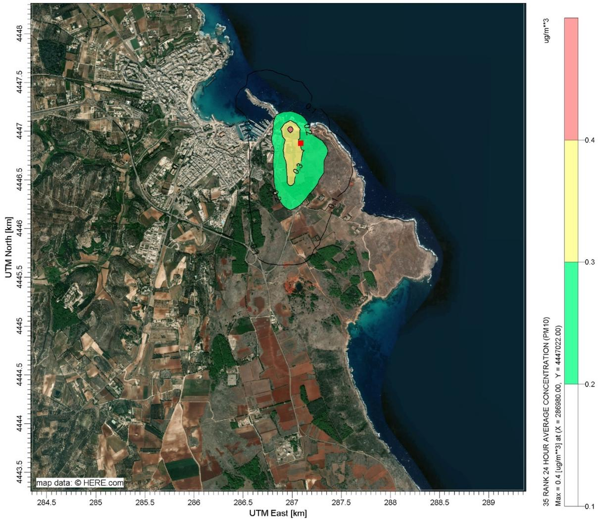
Figura 5.13: Fase Realizzazione TOC - Mappa di Iso-concentrazione, 90.4° Percentile delle Concentrazioni Giornaliere di PM<sub>10</sub>
