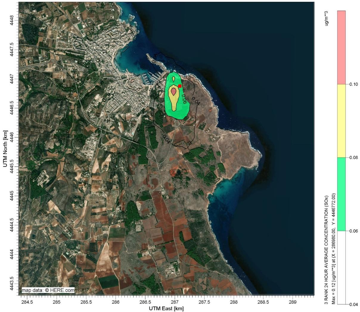
Figura 5.11: Fase Realizzazione TOC - Mappa di Iso-concentrazione, 99.2° Percentile delle Concentrazioni Giornaliere di SO<sub>x</sub>
