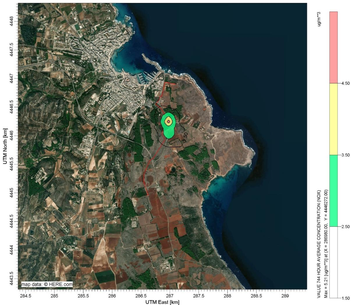
Figura 5.20: Fase Realizzazione del Metanodotto On Shore, Tratto 2 - Mappa di Iso-concentrazione, Media Mensile delle Concentrazioni di NO<sub>x</sub> (Gennaio)
