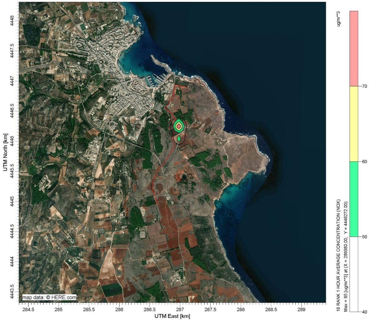
Figura 5.17: Fase Realizzazione del Metanodotto On Shore, Tratto 2 - Mappa di Iso-concentrazione, 18° valore delle Concentrazioni Orarie di NO<sub>x</sub> (Gennaio)
