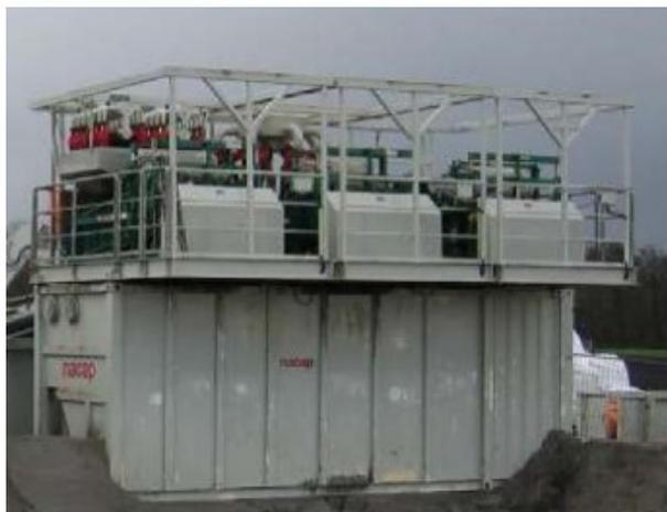
Figura 3.25: Esempio di Unità di Riciclo Fanghi
