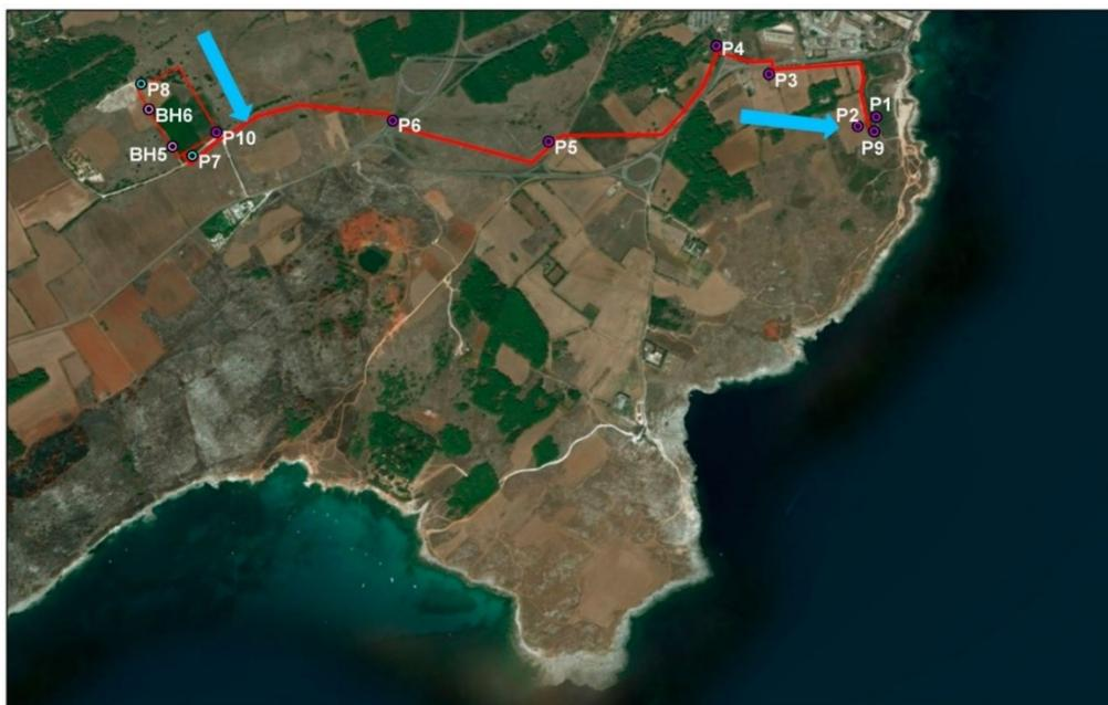
Figura 7.5: Localizzazione Piezometri e Direzione della Falda
