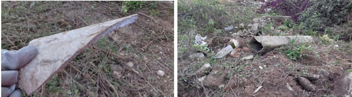
**Figura 4.34: Frammenti (a Sinistra) e Manufatti (a Destra) potenzialmente Contenenti Amianto nell'Area del Rilevato**
