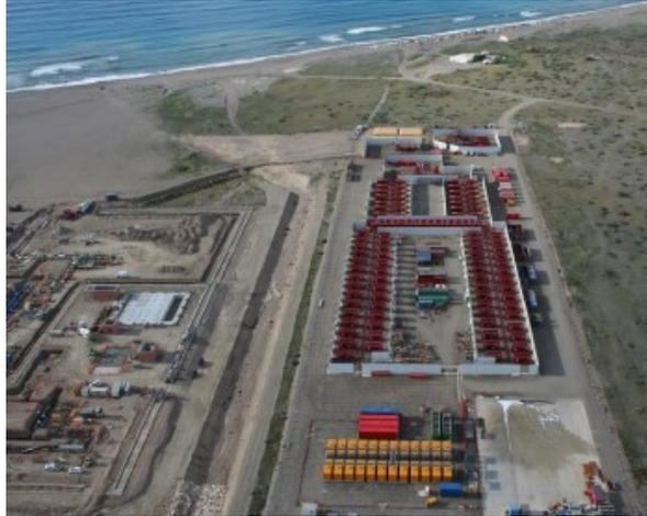
Figura 3.33: Esempio di Pre-Commissioning Spread
