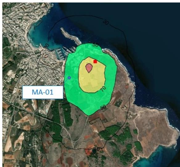
**Figura 7.1: Stima Modellistica della Massima Ricaduta di NO<sub>x</sub> (Ossidi di azoto) - 99.8° Percentile delle Concentrazioni Orarie - Perforazione TOC e Posizione Stazione Monitoraggio MA-01**
