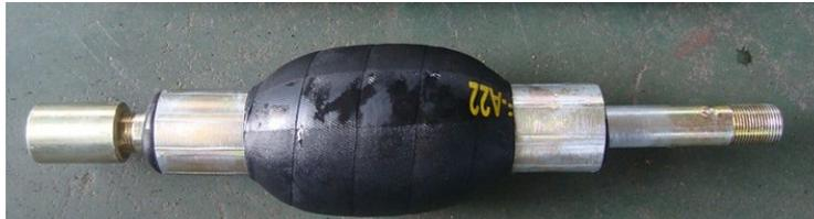
Figura 3.22: Esempio di Packer Pressurizzato
