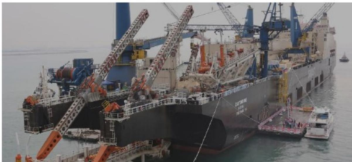
Figura 3.6: Esempio di Nave Posatubi - Castorone
