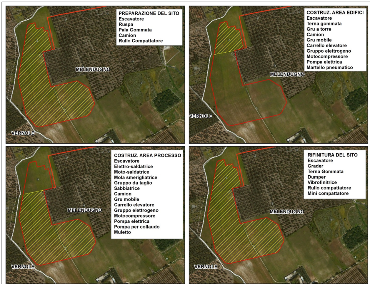
Figura 7.1 Aree di Cantiere del PRT
