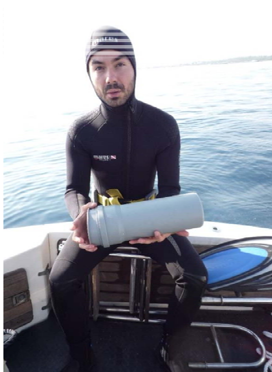
Figura 3-15: Il carotatore impiegato in immersione per il campionamento sui fondi mobili
