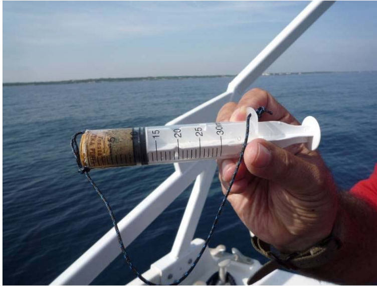
Figura 3-16: La siringa tagliata utilizzata per il prelievo del sedimento in immersione per la raccolta del microfitobenthos sui fondi mobili
