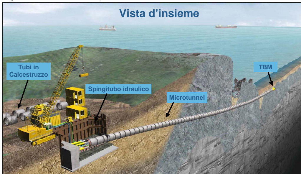
Figura 2-3 Sezione tipo di Microtunnel
