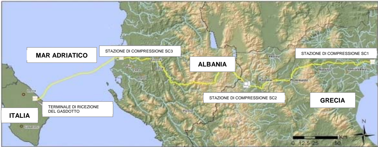
Figura 1-1 – Trans Adriatic Pipeline – Visione d’insieme
