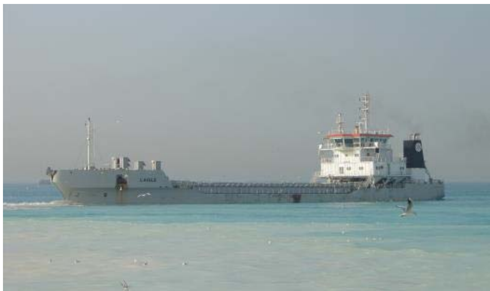
Figura 8-2 : Tipica bettolina (Split Hopper Barge) 'l'Aigle'
