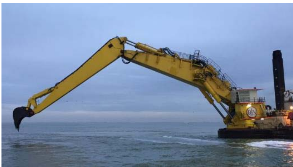
Figura 8-4 :Tipica configurazione per dragaggio in profondità della draga escavatrice (Backhoe Dredger) 'Mimar Sinan'
