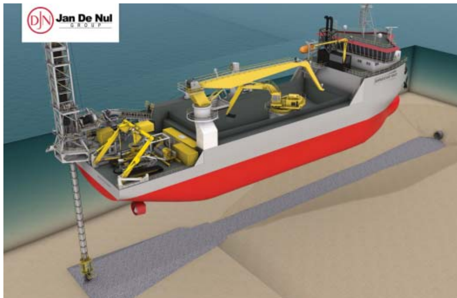
Figura 11-2 Riempimento del terrapieno da parte della nave
