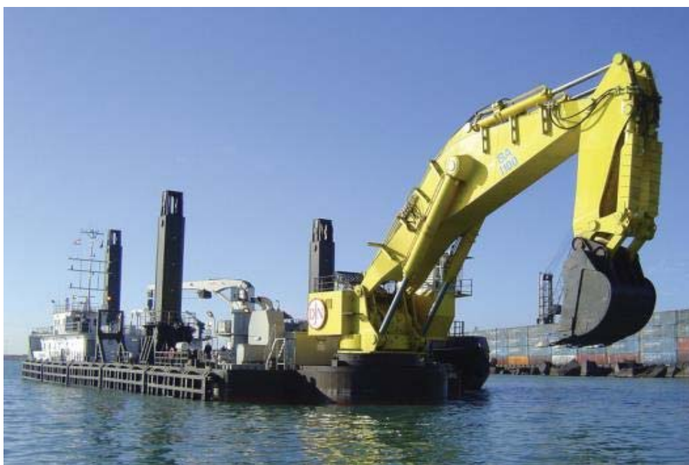
Figura 8-1 : Tipica Draga Escavatrice (Backhoe Dredger) 'Mimar Sinan'
