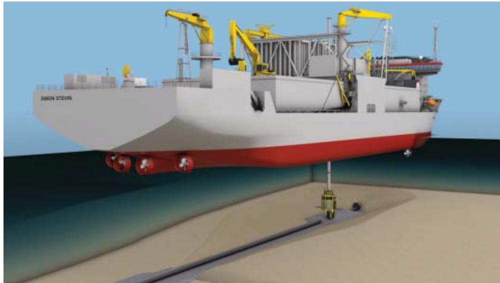
Figura 15-32 : Installazione della ghiaia con (FPV) 'Simon Stevin'
