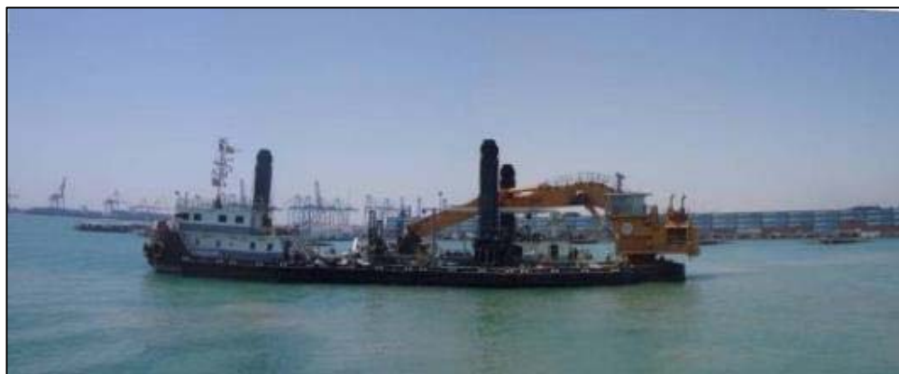
Figura 8-3: Draga Escavatrice (Backhoe Dredger)
