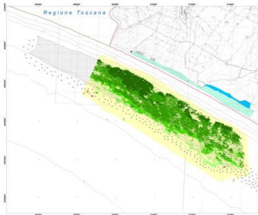
Figura 29 Posizionamento delle strutture antistrascico a protezione della prateria di Posidonia tra la foce del Chiarone e Morelle (Lazio settentrionale)
