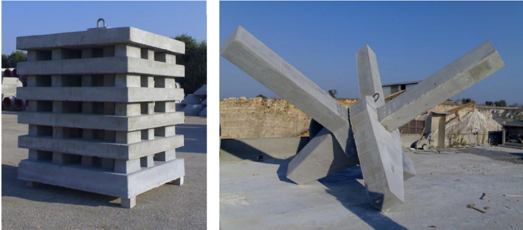
Figura 36 Il modulo di sviluppo AFEER (a sinistra) e di protezione utilizzato a Frigole
