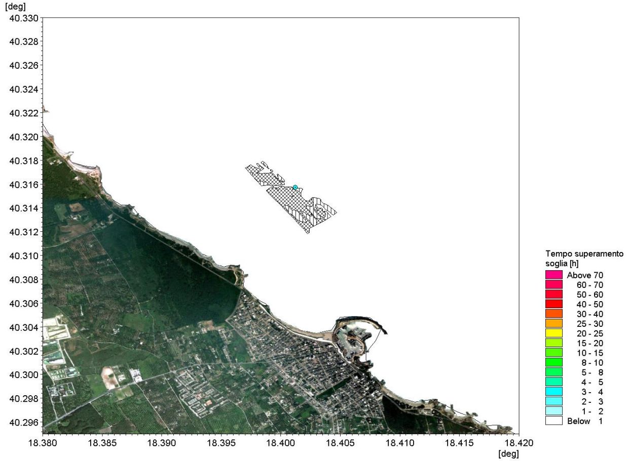
Figura 7-25 Riempimento: persistenza temporale degli eventi con concentrazione superiore ai 10 mg/l su base annuale (ad eccezione dei mesi estivi) nei periodi di inattività - superficie
