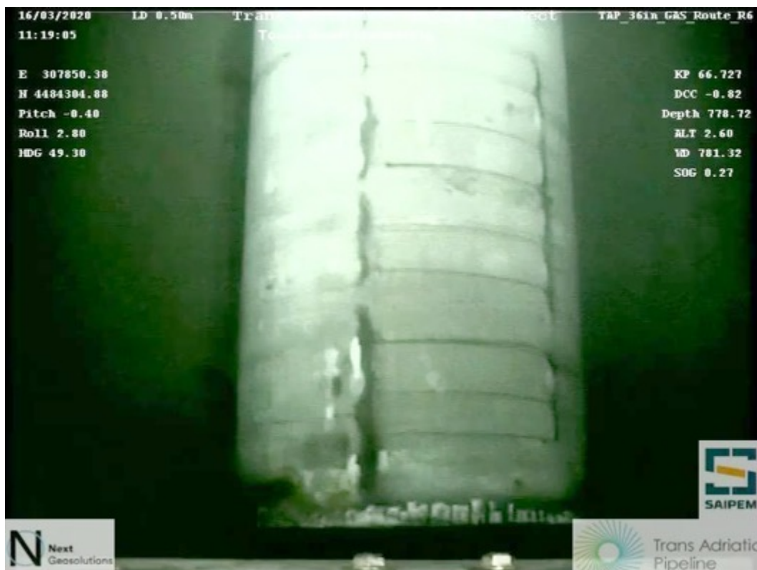
Figura 29. KP66.727, condotta posata all'interno dell'area del CF 02/2018 (Cfr. Figura 25 – Foto_04)
