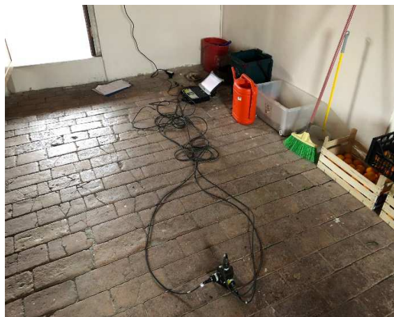
Posizionamento accelerometri monoassiali, piano primo
