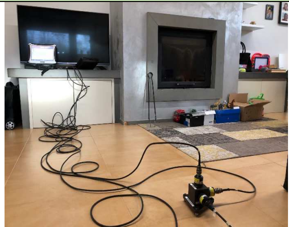
Posizionamento accelerometri monoassiali, piano primo
