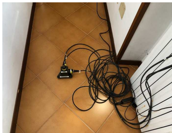
Posizionamento accelerometro monoassiale, piano terra
