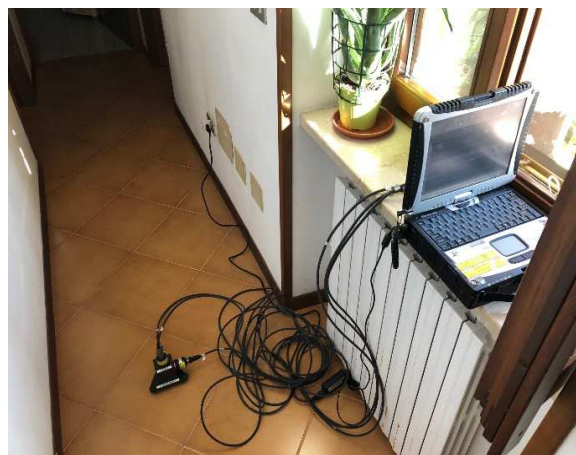
Posizionamento accelerometro monoassiale, piano primo
