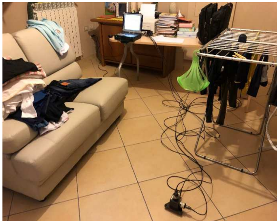
Posizionamento accelerometri monoassiali, piano terra
