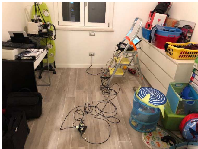
Posizionamento accelerometri monoassiali, piano terra
