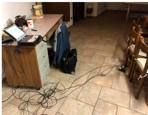
Posizionamento accelerometri monoassiali, piano terra
