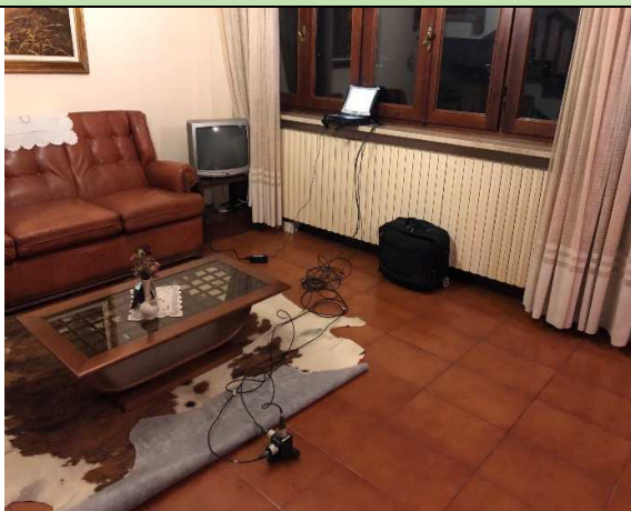
Posizionamento accelerometri monoassiali, piano terra
