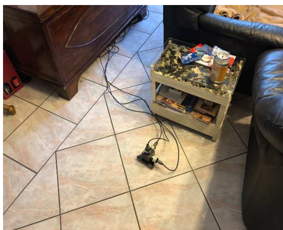
Posizionamento accelerometri monoassiali, piano terra
