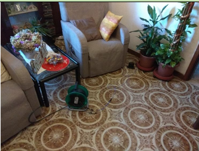
Posizionamento accelerometro monoassiale, 1° piano f.t.
