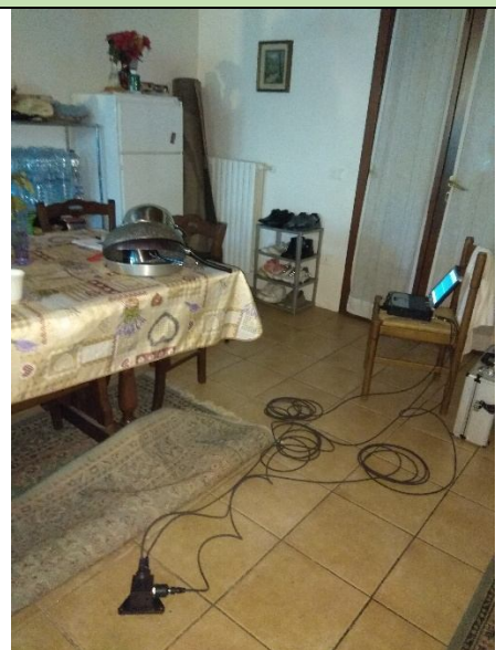
Posizionamento accelerometro monoassiale, 1° piano f.t.
