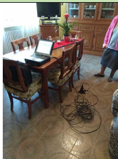
Posizionamento accelerometro monoassiale, 2° piano f.t.
