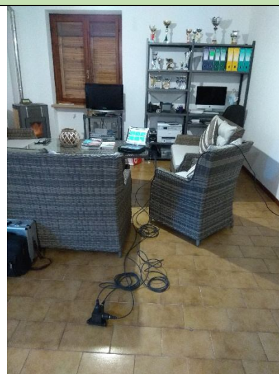
Posizionamento accelerometro monoassiale, 1° piano f.t.
