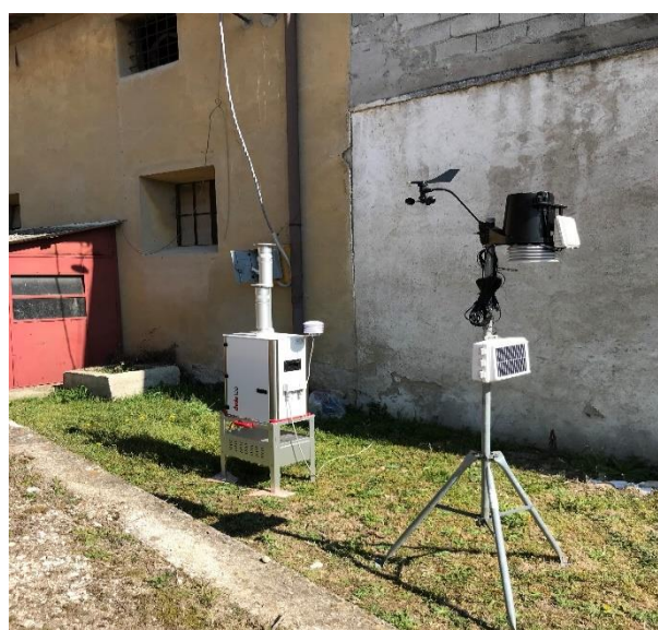
Figure 4.1 - Allestimento Laboratorio Mobile – Analizzatori e Campionatori Sequenziali
