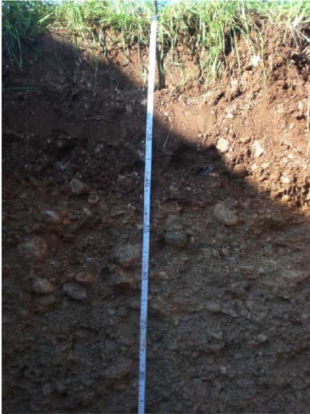
Fot. 3 Profilo AV-CA-A1-ST-05-GR2-02 dettaglio Orizzonte Ap (0-40 cm) e B (40-55 cm)
