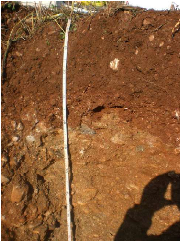
Fot. 3 Profilo AV-LO-EST-GR2-11 dettaglio Orizzonte Ap (0-38 cm) e B (38-53 cm)
