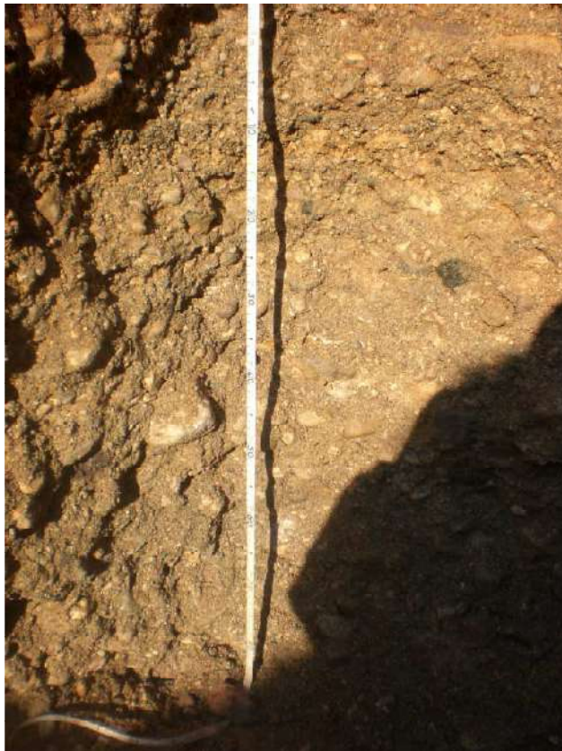
Fot. 5 Profilo AV-LO-EST-GR2-11 dettaglio Orizzonte Ck (120-190 cm)
