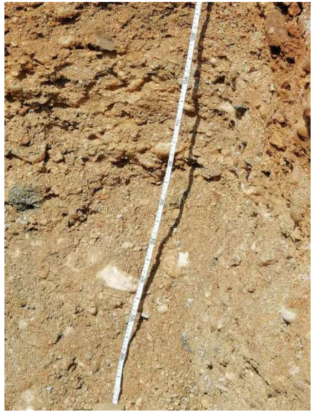
Fot. 4 Profilo AV-LOW-GR2-17 dettaglio Orizzonte Ck1 (85-120 cm) e Ck2 (120-170 cm)
