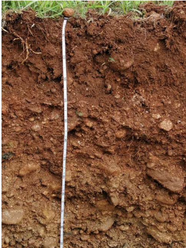
Fot. 3 Profilo AV-LOW-GR2-15 dettaglio Orizzonte Ap (0-40 cm) e B (40-70 cm)
