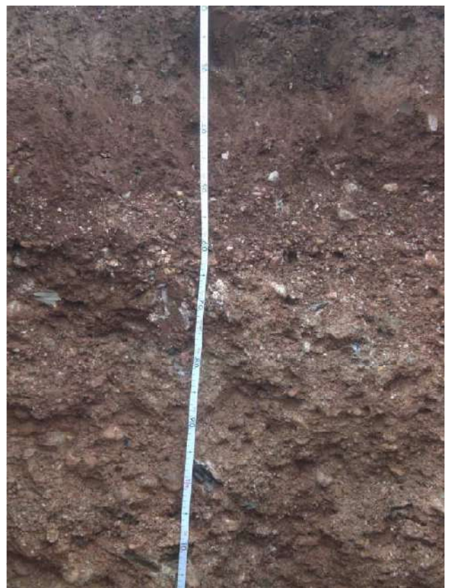
Fot. 4 Profilo AV-LO-A1-ST-08-GR2-14 dettaglio Orizzonte B2 (50-65 cm) e parte BC (65-135 cm)
