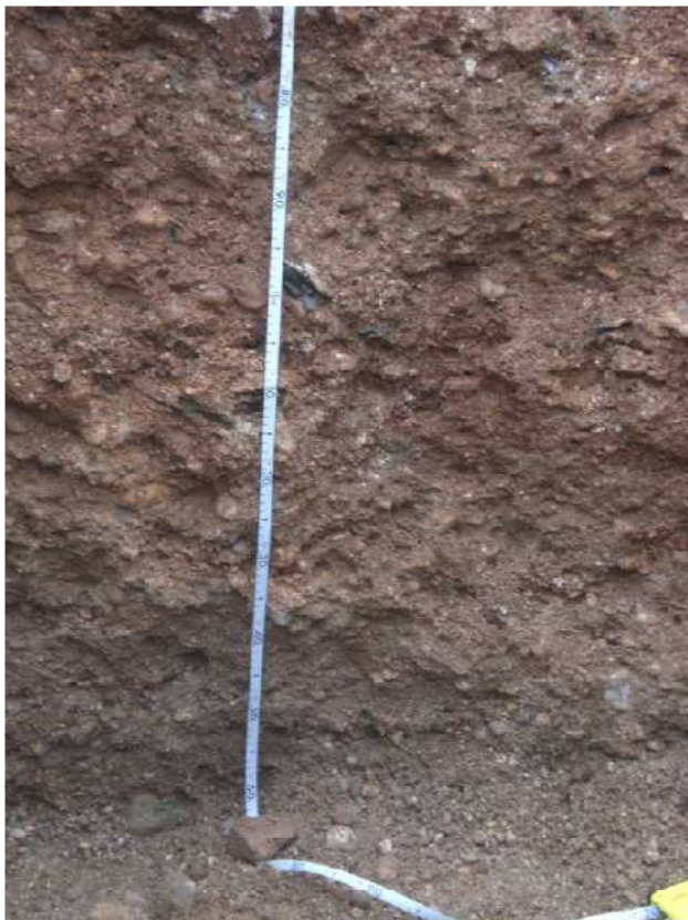
Fot. 5 Profilo AV-LO-A1-ST-08-GR2-14 dettaglio Orizzonte parte BC (65-135 cm) e C (135-65cm)
