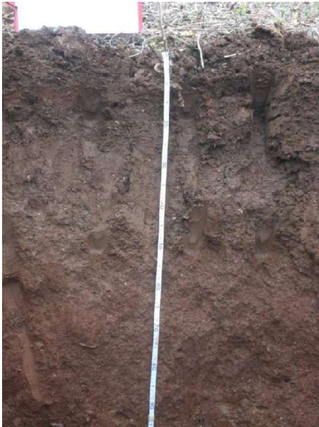
Fot. 3 Profilo AV-LO-A1-ST-08-GR2-07 dettaglio Orizzonte Ap (0-40 cm) e AB (40-70 cm)
