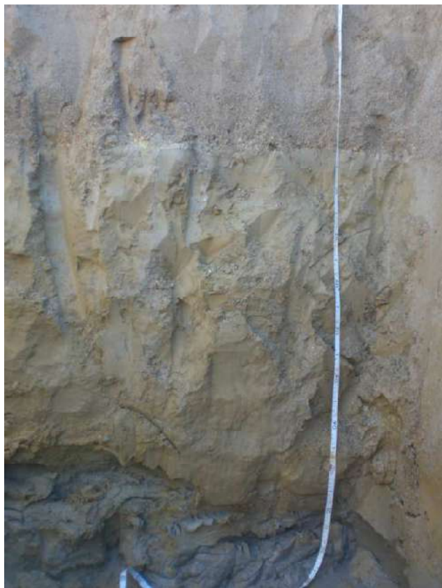
Fot. 5 Profilo AV-DE-A3-ST-06-GR2-06 dettaglio Orizzonte C2 (130-210 cm) e Cg3 (210-220 cm)
