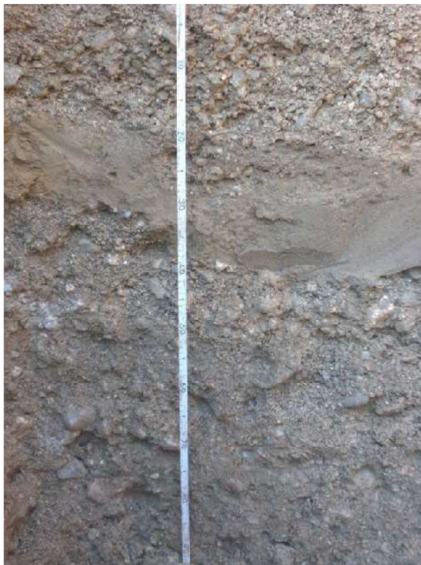
Fot. 5 Profilo AV-CA-A1-ST-05-GR2-02 dettaglio Orizzonte C2 (120-140 cm) e Ck3 (140-190 cm)
