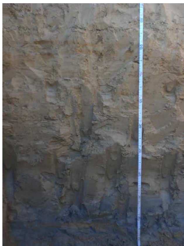
Fot. 4 Profilo AV-DE-A3-ST-06-GR2-09 dettaglio Orizzonte B2 (85-150 cm) e BC (150-170 cm)
