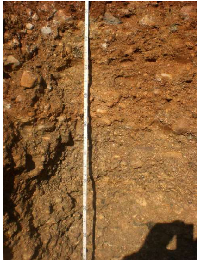
Fot. 4 Profilo AV-LO-EST-GR2-11 dettaglio Orizzonte BC (53-88 cm) e CB (88-120 cm)
