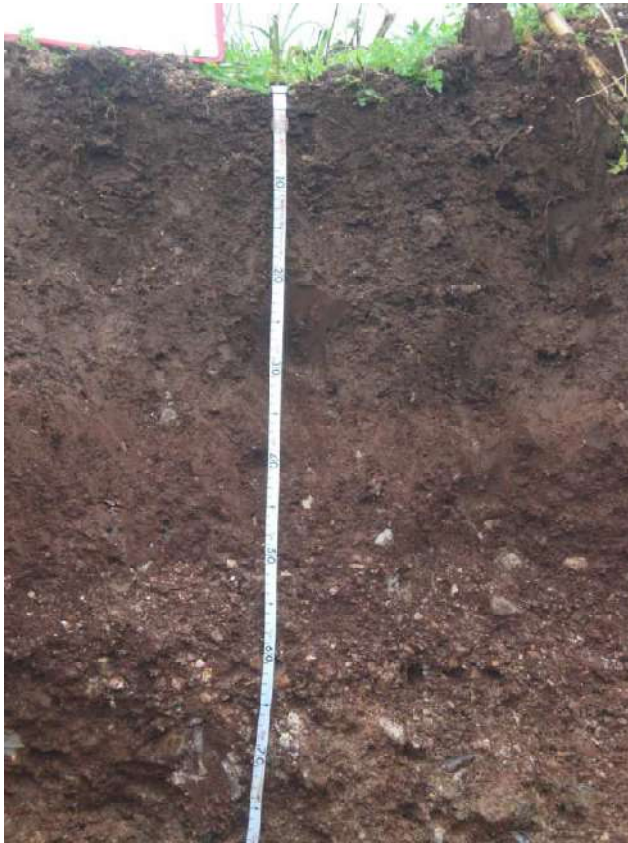
Fot. 3 Profilo AV-LO-A1-ST-08-GR2-14 dettaglio Orizzonte Ap (0-30 cm) e B1t (30-50 cm)
