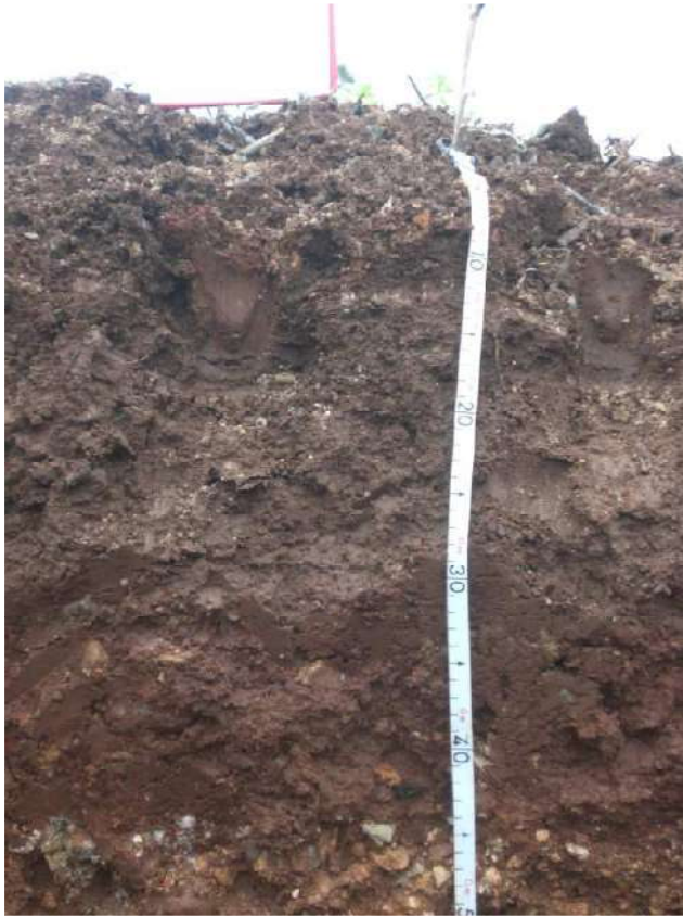
Fot. 3 Profilo AV-LO-A1-ST-08-GR2-11 dettaglio Orizzonte Ap (0-30 cm) e Bt (30-45 cm)
