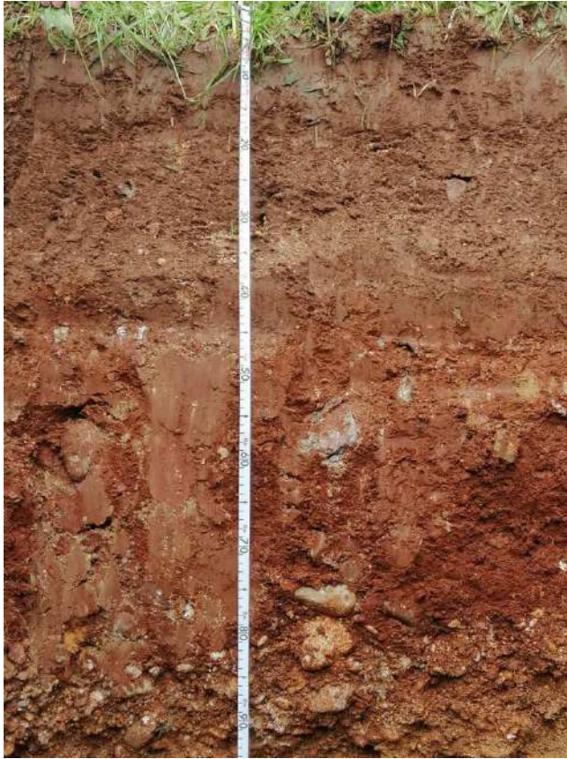
Fot. 3 Profilo AV-LOW-GR2-09 dettaglio Orizzonte Ap (0-40 cm) e Bt (40-80 cm)
