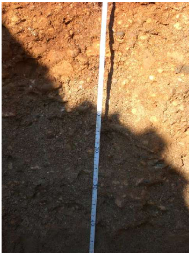
Fot. 5 Profilo AV-LO-EST-GR2-05 dettaglio Orizzonte C1 (100-140 cm) e C2 (140-160 cm)
