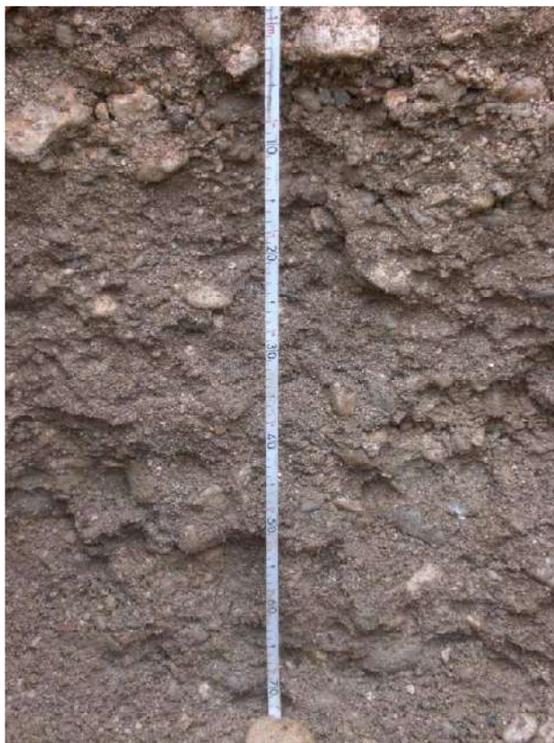
Fot. 5 Profilo AV-CA-A1-ST-07-GR2-04 dettaglio Orizzonte Ck (90-170 cm)
