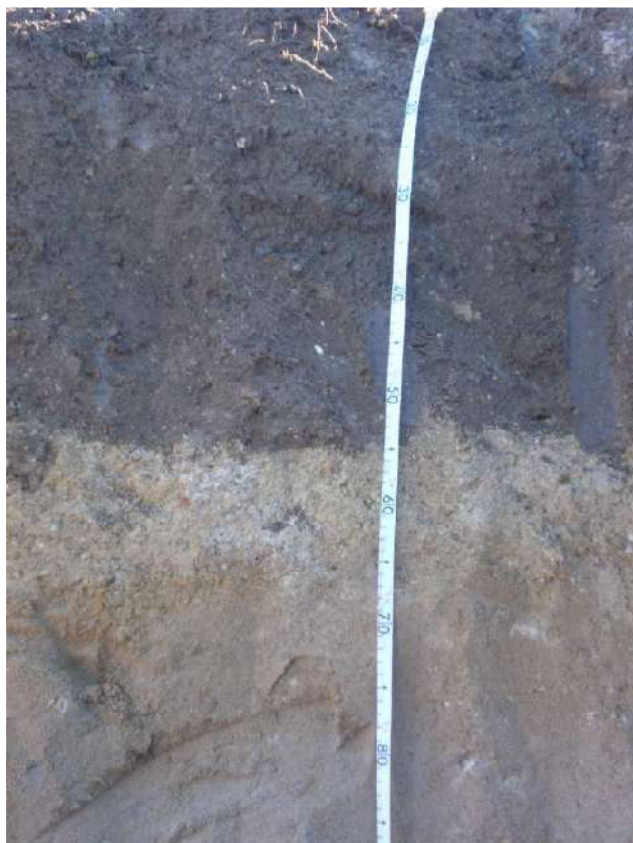
Fot. 3 Profilo AV-DE-A3-ST-06-GR2-06 dettaglio Orizzonte Ap (0-55), BC1 (55-65) e CB2 (65-78)
