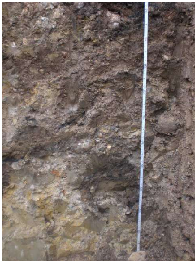
Fot. 5 Profilo AV-DE-A3-ST-05-GR2-01 dettaglio Orizzonte BCg (145-170 cm) e CgB (170-190 cm)
