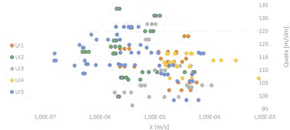
Figura 3-3: Confronto della distribuzione delle permeabilità orizzontali ricavate da prove di assorbimento Lefranc e loro variazione con la profondità.
