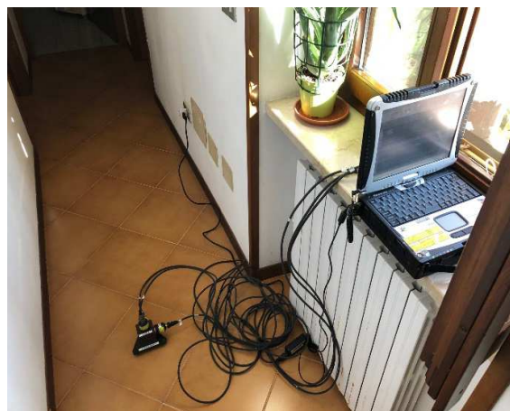
Posizionamento accelerometro monoassiale, piano primo
