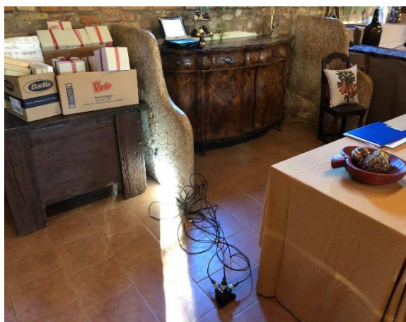
Posizionamento accelerometri monoassiali, piano terra
