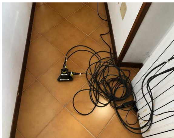
Posizionamento accelerometro monoassiale, piano terra
