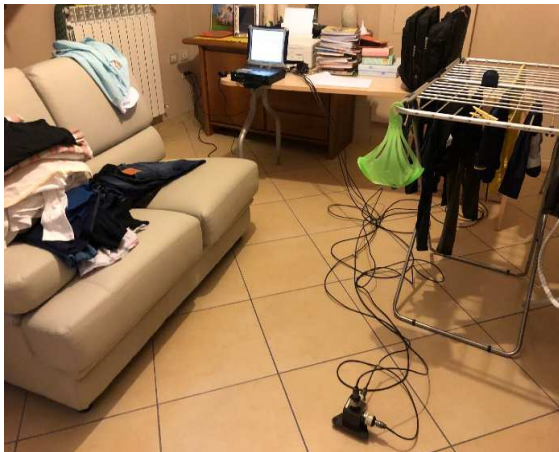
Posizionamento accelerometri monoassiali, piano terra
