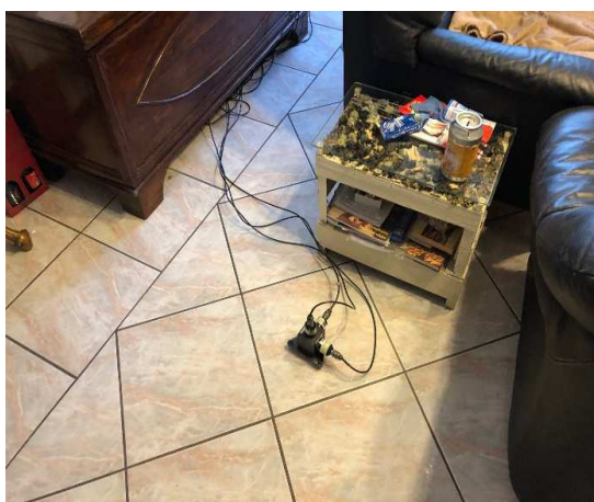
Posizionamento accelerometri monoassiali, piano terra
