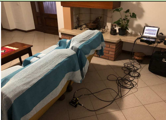
Posizionamento accelerometri monoassiali, piano terra
