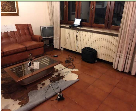
Posizionamento accelerometri monoassiali, piano terra
