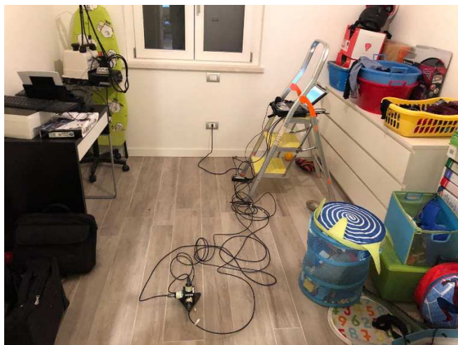
Posizionamento accelerometri monoassiali, piano terra
