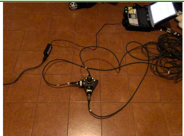
Posizionamento accelerometri monoassiali, piano primo
