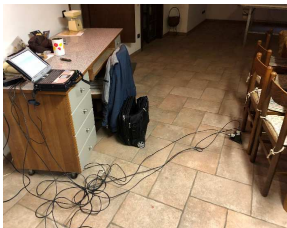
Posizionamento accelerometri monoassiali, piano terra
