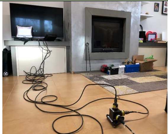
Posizionamento accelerometri monoassiali, piano primo
