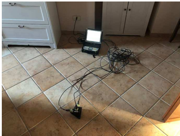
Posizionamento accelerometri monoassiali, piano terra
