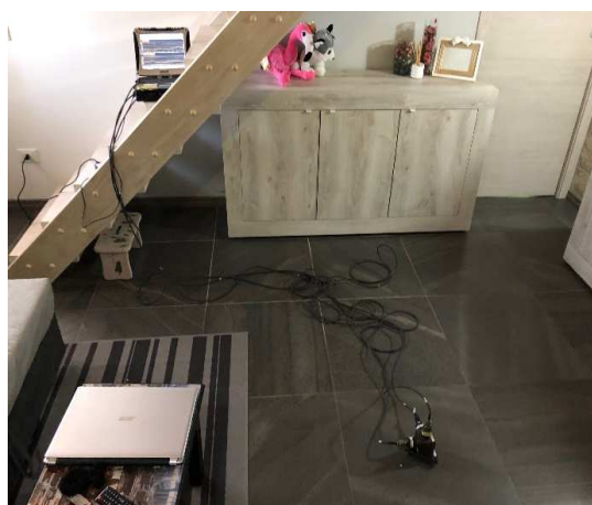
Posizionamento accelerometri monoassiali, piano primo
