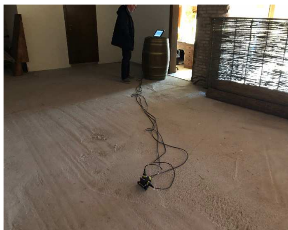
Posizionamento accelerometri monoassiali, piano primo
