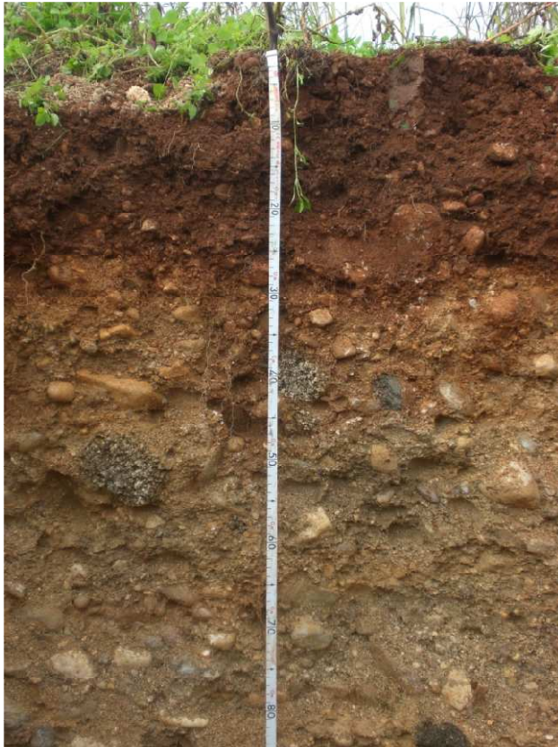
Fot. 3 Profilo AV-CA-A1-ST-06-GR2-02 dettaglio Orizzonte Ap (0-28 cm), B (28-40 cm) e BC (40-80cm)
