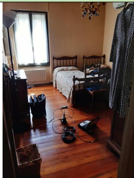
*Posizionamento accelerometri monoassiali, piano primo (camera da letto)*
