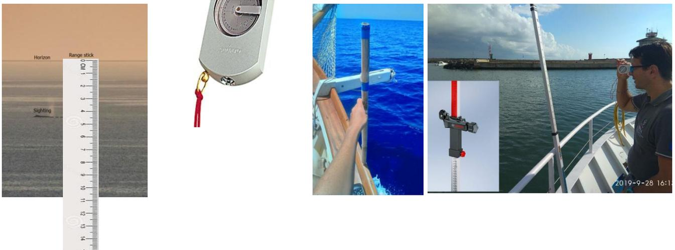
Fig. 4. Esempio di strumenti per il calcolo della distanza: telemetro a righello e clinometro e per fissare il margine esterno della striscia
