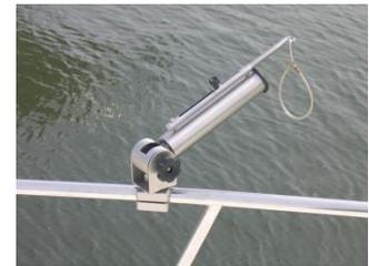
Fig. 6. Esempio di asta sporgente per imbarcazioni di media grandezza
